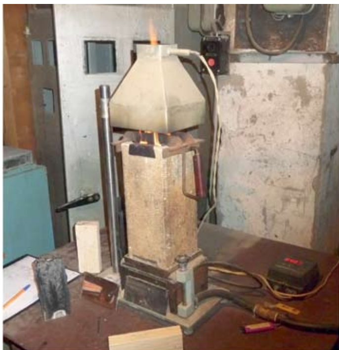
Рис. 1. Общий вид установки «керамическая труба» для оценки эффективности огнезащитных составов
